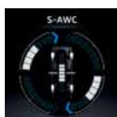
Система повного привода «Super All Wheel Control» (S-AWC) забезпечує оптимальний розподіл крутного моменту між колесами для поліпшення динаміки, керованості та прохідності автомобіля. Вона застосовує систему покращення характеристик керованості «Active Yaw Control» (AYC), яка передбачає вибіркове застосування гальм для оптимального розподілу крутного моменту між передніми колесами.
