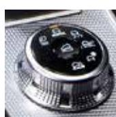
Водій може самостійно вибрати один із шести режимів роботи системи: NORMAL, ECO, TARMAC, GRAVEL, SNOW та MUD (лише для повноприводних моделей).
